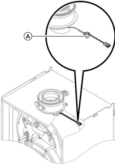
1. Leitungen am Abgastemperatur-sensor **A** abziehen.
