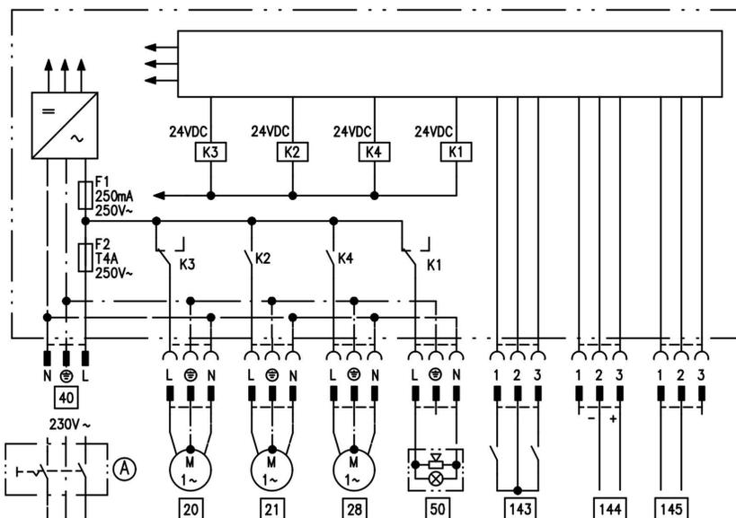
Die externe Erweiterung wird über den KM-BUS an die Regelung des Heizkessels angeschlossen. Über die Erweiterung können folgende Funktionen gleichzeitig angesteuert bzw. verarbeitet werden:
