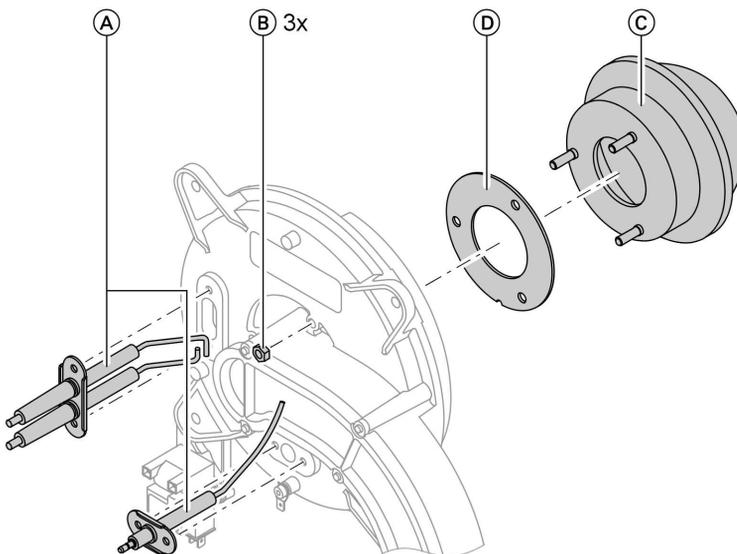
1. Elektroden (A) ausbauen.
