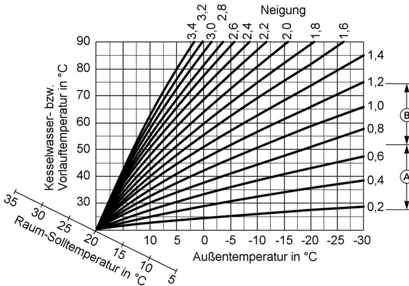
(A) Neigung der Heizkennlinie bei Fußbodenheizungen
