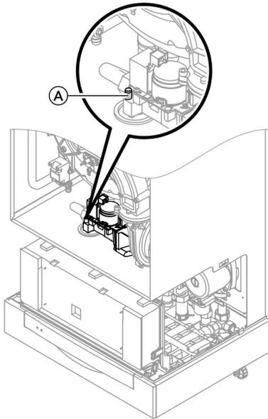
2. Schraube (A) im Mess-Stutzen „PE“ am Gaskombiregler lösen, nicht herausdrehen, und Manometer anschließen.
