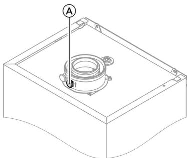
1. Abgasanalysegerät an Öffnung Abgas (A) am Kesselanschluss-Stück anschließen.
