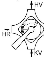
Schalterstellung II für Heizungs-rücklauf von rechts.
