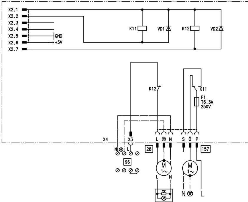
Die interne Erweiterung wird in das Regelungsgehäuse eingebaut. An den Relaisausgang **28** können folgende Funktionen alternativ angeschlossen werden. Die Funktion wird über die Codieradresse „53“ zugeordnet:
