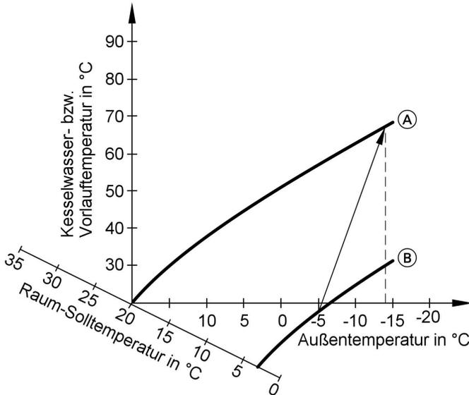
Ⓐ Heizkennlinie für Betrieb mit normaler Raumtemperatur
