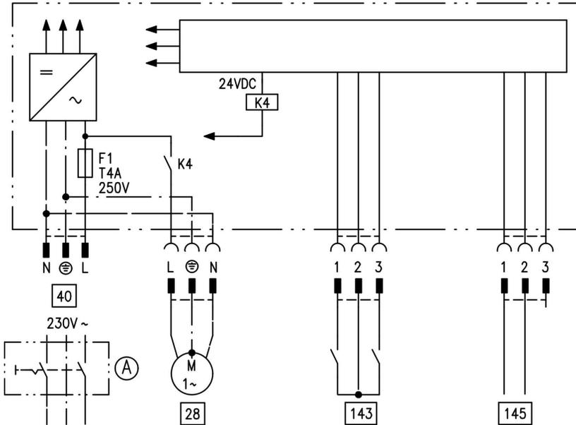
Die externe Erweiterung wird über den KM-BUS an die Regelung des Heizkessels angeschlossen. Über die Erweiterung können folgende Funktionen gleichzeitig angesteuert bzw. verarbeitet werden:
