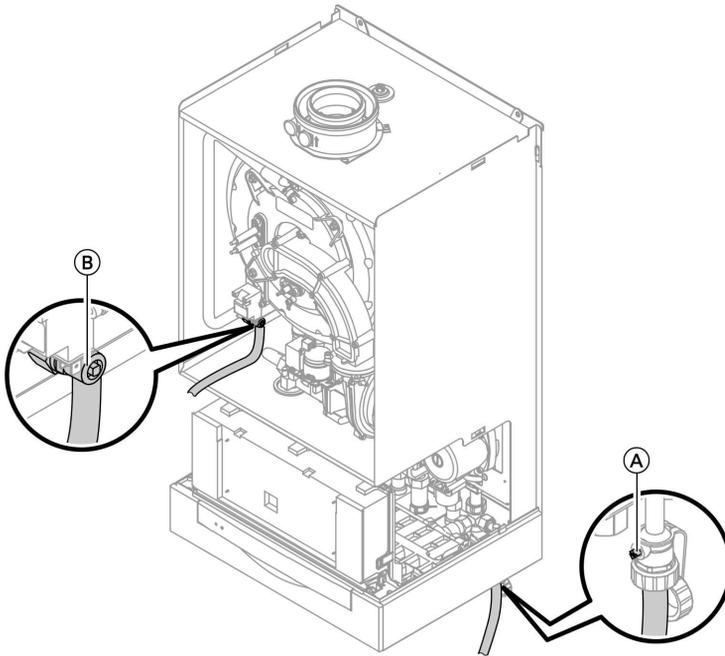
1. Heizwasserseitige Absperrventile schließen.
