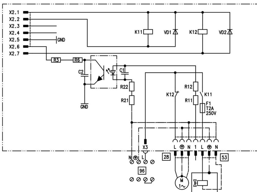
Die interne Erweiterung H1 ist im Regelungsgehäuse eingebaut. An den Relaisausgang 28 können folgende Funktionen alternativ angeschlossen werden. Die Funktion wird über die Codieradresse „53“ zugeordnet:
