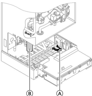
1. Ungehinderten Abfluss des Kondenswassers am Siphon prüfen.
