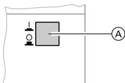
1. Netzschalter (A) am Erweiterungssatz ausschalten und wieder einschalten. Das Gerät führt folgenden Eigentest aus:
